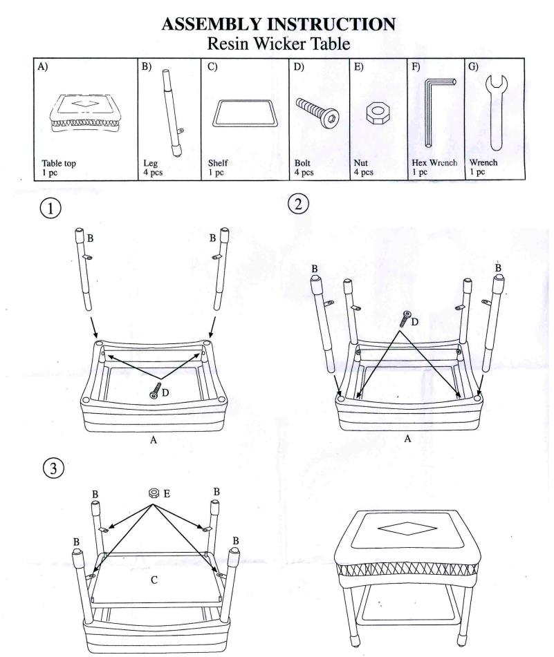
\*\* BE SURE ALL FASTENERS ARE FULLY TIGHTENED BEFORE USING THE ITEM.
